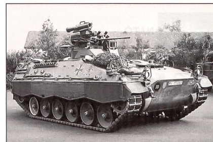
Schützenpanzer «Marder 1» mit 2-cm-Maschinenkanone und MILAN-PAL.
