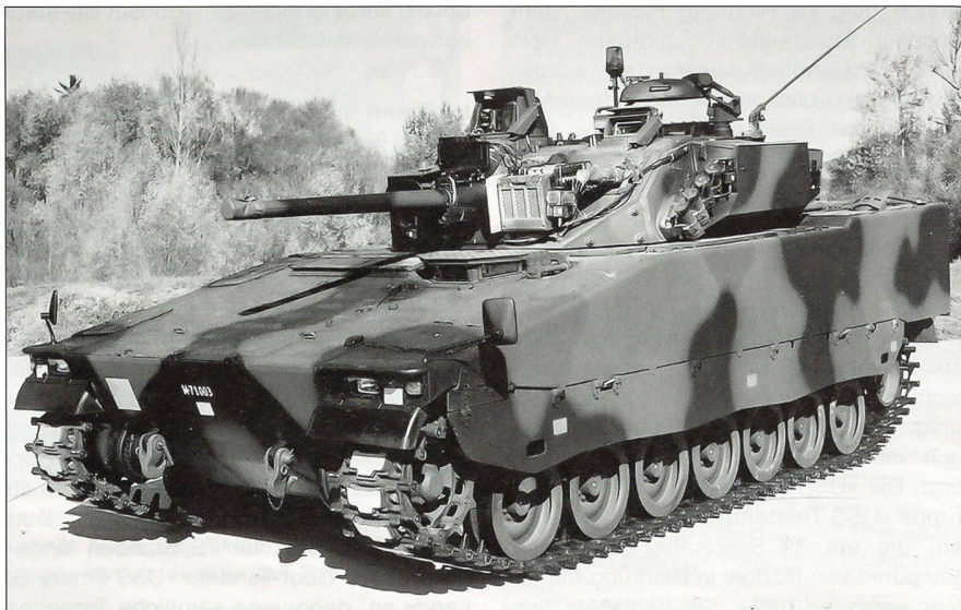
Die Schweizer Version des CV-9030 mit dem am Turm montierten Laser-Schiesssimulator.
