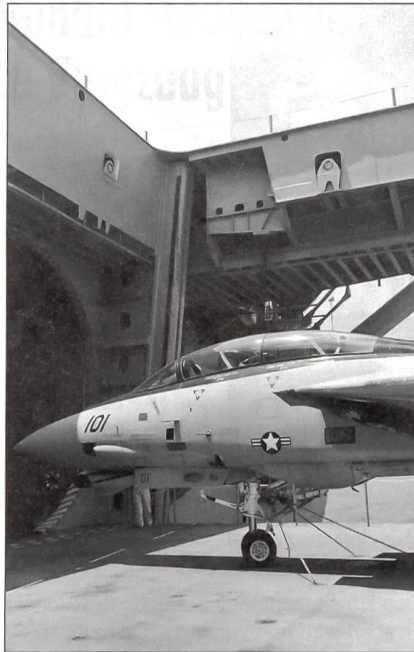
Gewaltige Flugzeuglifte (deren vier sind vorhanden) befördern die bis zu 80 Flugzeuge des Marinefliegergeschwaders vom Hangardeck auf das Flugdeck. Hier ist eine F-14D Tomcat der Fighter Squadron VF-213 auf dem Lift Nr. 4 geparkt.
