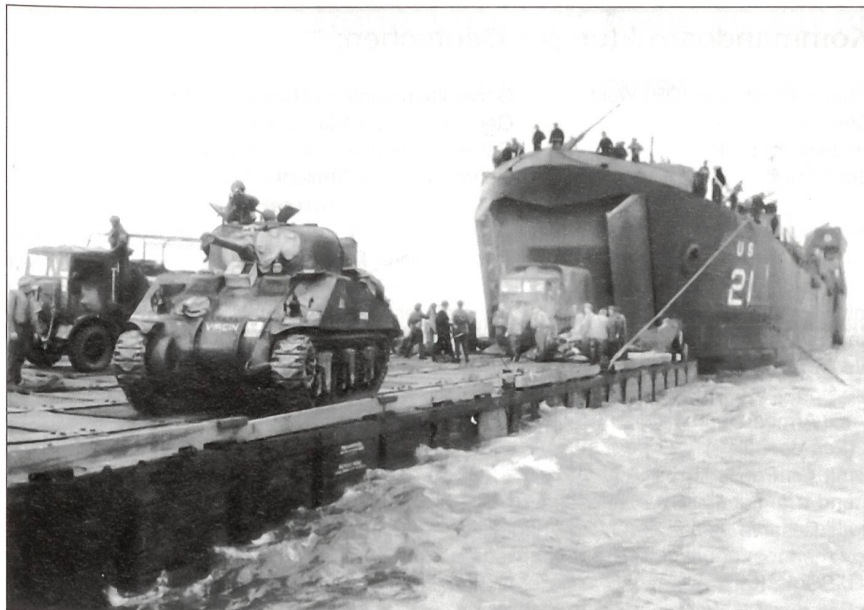
Nach Erstürmung des Landestrandes können in einer zweiten Welle die nachfolgenden Elemente weitgehend unbeeinträchtigt ihre Panzer des Typs Sherman aus Landungsschiffen des Typs LST ausladen. Über Schwimmpontons fahren die Panzer ans Ufer.
