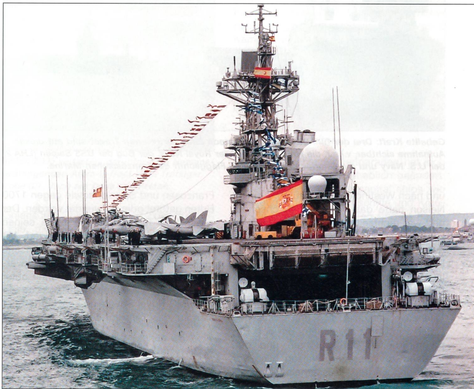
Spanien schickte das Flaggschiff seiner Flotte, den 17 100 t grossen Helikopterträger Principe de Asturias (R 11) an die Fleet Review 2005 nach England. Das Schiff kann eine variierende Zusammensetzung von 6 bis 12 AV-8B-Harrier-Senkrechtstartern und/oder 6 bis 10 SH-3-Sea-King-Helikoptern aufnehmen.
