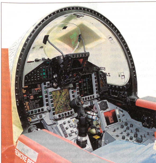
Das Layout des Cockpits des Eurofighter erleichtert dem Piloten dank modernsten elektronischen Hilfen die Erfüllung des Auftrages. Auf den verschiedenen Bildschirmen können alle wichtigen Informationen abgerufen werden.
