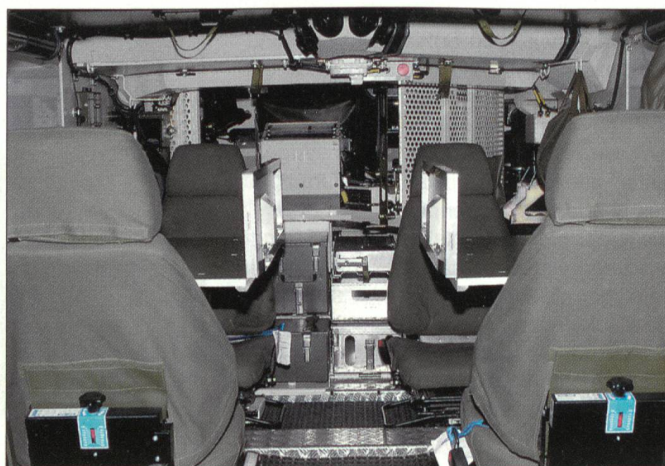
Ein Blick in das Innere des Schützenpanzers 2000 zeigt die Arbeitsplätze des Kommandanten und seiner Führungsgehilfen.
