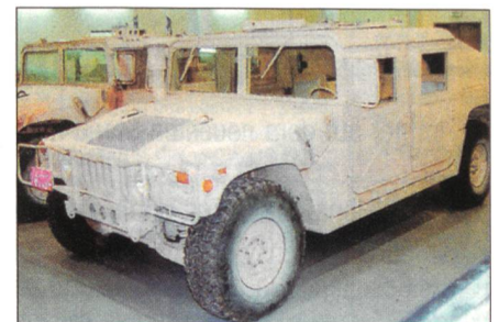
Humvee mit Minenschutz der Firma LMT Technologies
