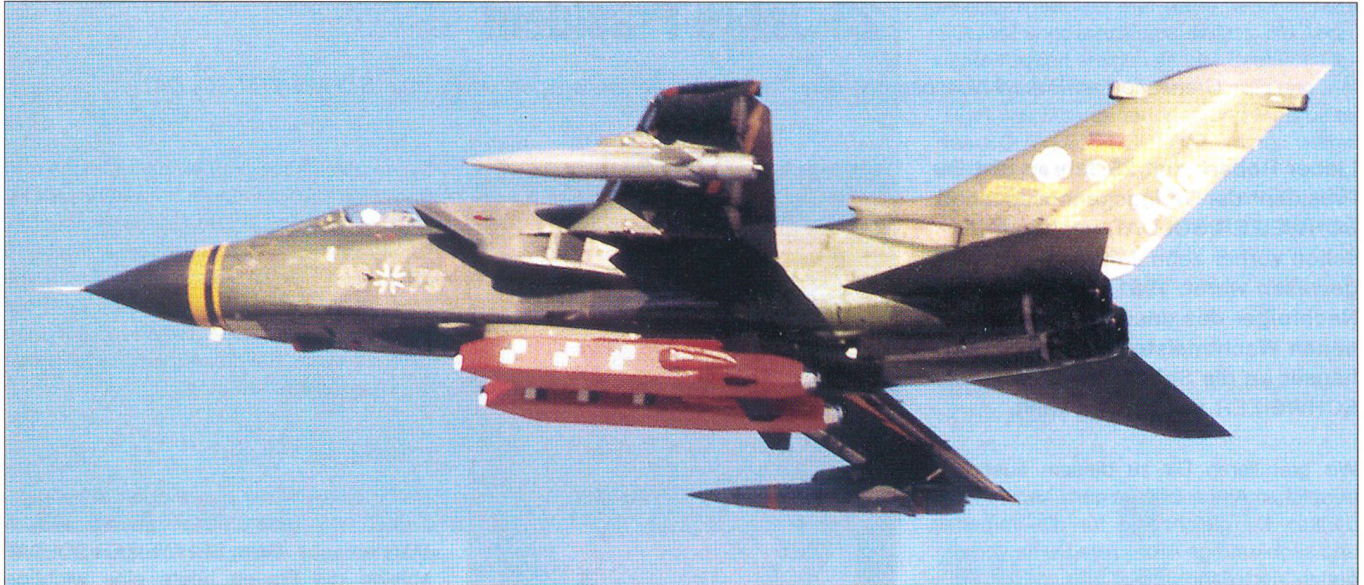
Der Luft-Boden-Marschflugkörper Taurus KEPD 350 (hier angehängt an einem Tornado-Kampfflugzeug) wird weiter ausgebaut. Er soll in Zukunft in der Lage sein, Ziele auf eine Distanz bis 500 km zu bekämpfen. Dank Data Link wird es möglich werden, den Auftrag während des bodennahen Fluges der Lenkwaffe zu überwachen, zu ändern oder den Einsatz abubrechen.
