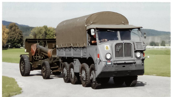
Der Saurer M-8, das Zugfahrzeug der Schwere Kanone – einst wohl beste Zugmaschine der gezogenen Schweizer Artillerie.
