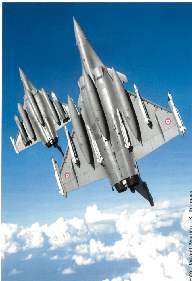
Eine Doppelpatrouille Rafale der französischen Luftwaffe, ausgerüstet mit drei Zusatztanks mit je 2000 Litern Treibstoff und sechs Luft-Luft-Lenk Waffen vom Typ MICA EM/IR.
