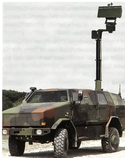
Bodenüberwachungsradar auf Dingo-2.
