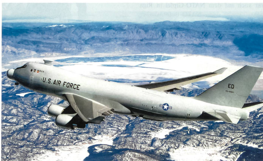
YAL-1, die erste von sieben zum Airborne-Laser umgebauten Boeing 747-400.
