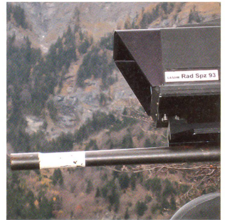
Laser-Aufsatz LASSIM auf Piranha.
