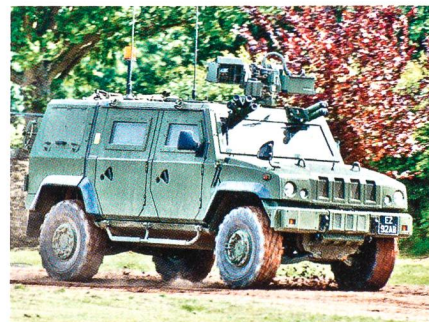
IVECO LMV mit fernbedienter Waffensystemstation.
