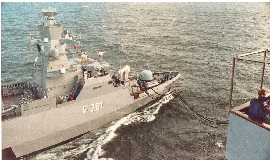
Die neue Korvette der deutschen Marine «Magdeburg» wird auf hoher See mit 76 m 3 Treibstoff vom Einsatzgruppenversorger «Frankfurt aM» versorgt.
