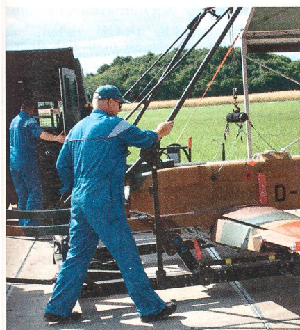
Das Bedienungspersonal schiebt die Drohne für den Start auf das Katapult, das stets von einem Zelt geschützt ist.
