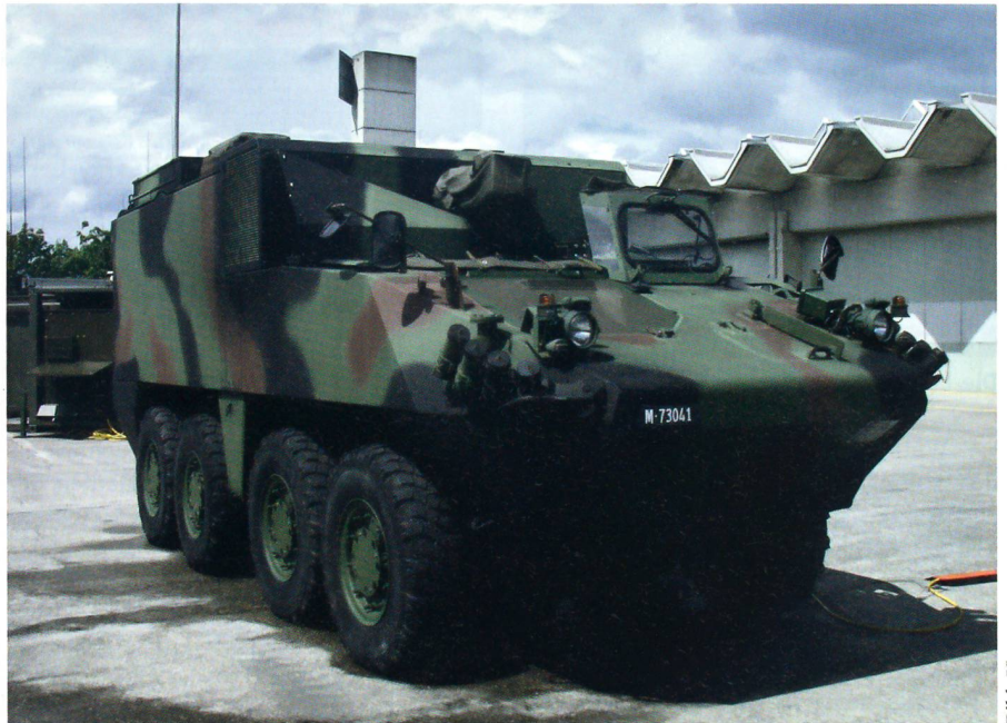
Ein Radschützenpanzer FIS im Auenfeld zu Frauenfeld. Unverkennbar ist es ein MOWAG Piranha. Typisch für den FIS-Panzer ist der Aufbau über dem Dach.
