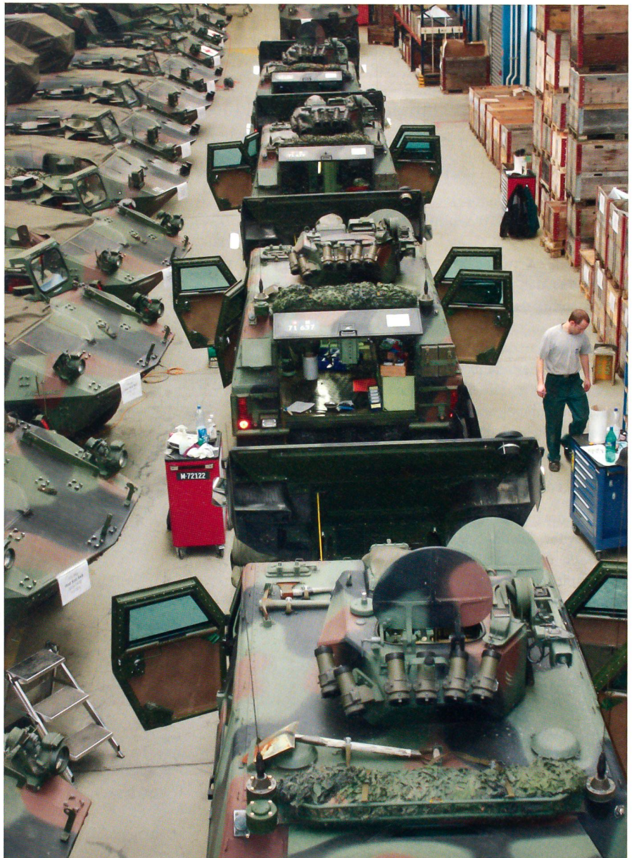
Der Blick in die Montagehalle im Spidertown Tägerwilen. In langen Strassen wird fünf verschiedenen Radfahrzeug-Typen das Führungsinformationssystem Heer eingebaut.
