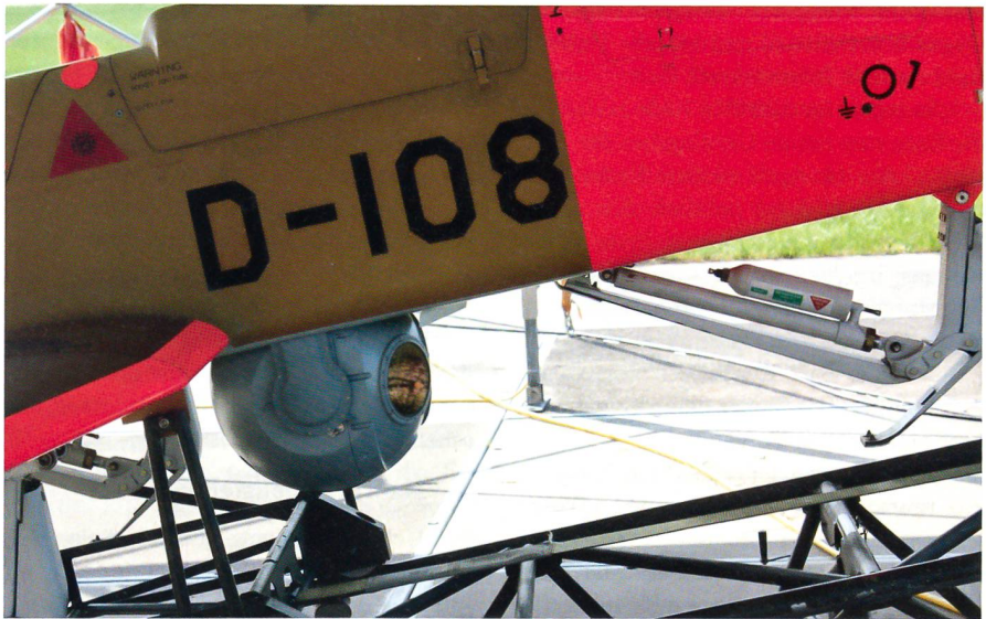
Die ADS-95-Drohne mit der kugelrunden Kamera auf der Rampe in Payerne.
