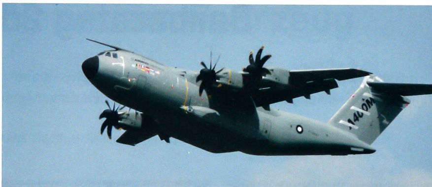
Der A400M hat ein Startgewicht von 130 Tonnen und kann zwischen 20 und 30 Tonnen Nutzlast mitführen. Die Besatzung besteht aus zwei Piloten und einem Verantwortlichen für die Last. Das Layout des Cockpits entspricht jenem der Airbus-Maschinen. Landen und Starten kann auch auf Naturpisten erfolgen.
