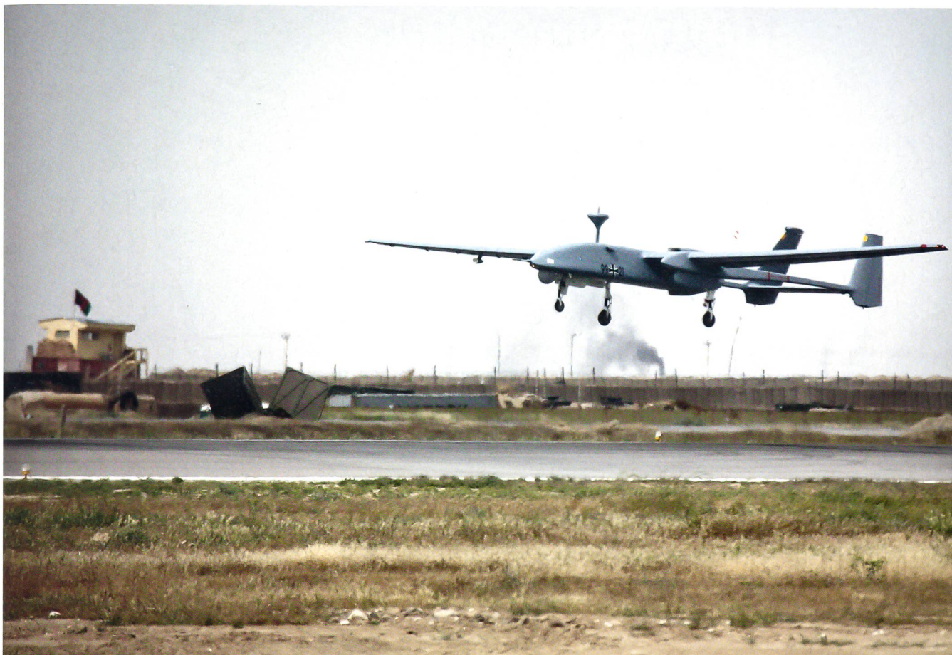
Die Drohne hat eine Flügelspannweite von 16,6 Metern, ein Startgewicht von 1200 Kilogramm, eine Nutzlast von 250 Kilogramm, operiert bis in eine Höhe von knapp 10 000 Metern und ist in der Lage über 30 Stunden zu fliegen.
