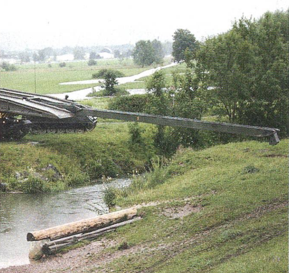
Der Brückenpanzer fährt den Arm aus.
