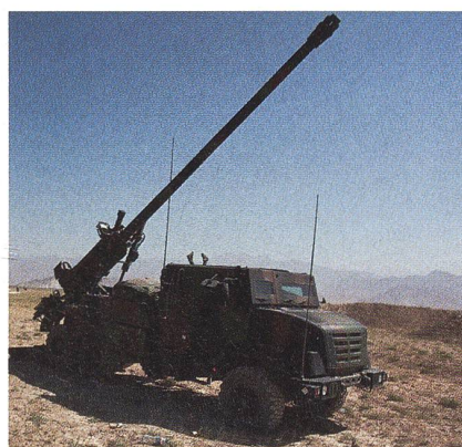
Frankreich: CAESAR (Camion Equipé d'un Système de Artillerie). Kaliber 155 mm. Rohrlänge 52 Kaliber. Gewicht 18 t. Distanz 40 km. 4 Schuss/min. Wirkungsbereich je 17 Grad. Munitionsvorrat 18 Geschosse. Bedienung vier Mann.
