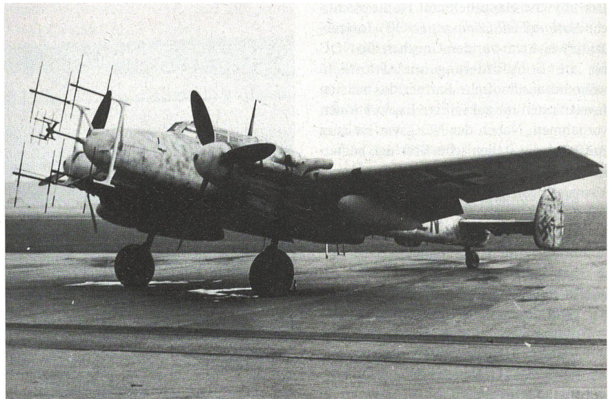
Der Nachtjäger Me 110 mit geheimer Antennenanlage auf dem Flugplatz Dübendorf.
