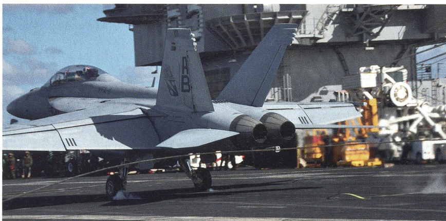
Eine F/A-18F der Fighter-Attack Squadron VFA-11 («Red Rippers») landet auf der USS «Enterprise» und erwischt das Fangseil Nummer 2 (von vier Fangseilen). Die mit etwa 240 km/h anfliegende Maschine wird dann auf einer Strecke von etwa 140 Metern zum Stillstand gebracht.
