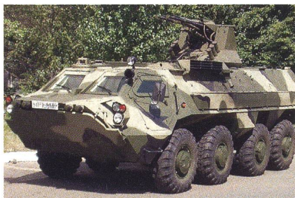
BTR-4 Radschützenpanzer mit fernbedienter Waffenstation und 23-mm-Zwillingskanone.
