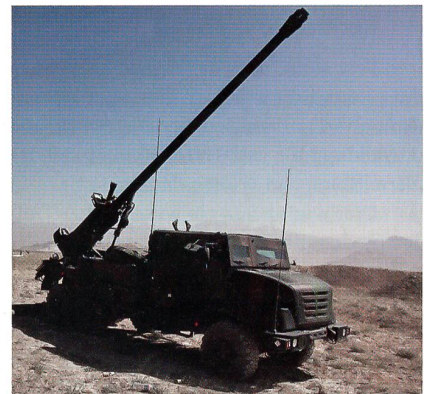
Frankreich: CAESAR (Camion Equipé d'un Système d'Artillerie). Kaliber 155 mm. Rohrlänge 52 Kaliber. Gewicht 18 t. Distanz 55 km. 6 Schuss/min. Wirkungsbereich je 17 Grad. Munitionsvorrat 18 Geschosse. Bedienung vier Mann.
