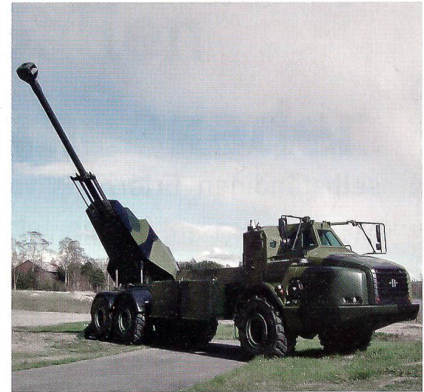
Schweden: Archer. Kaliber 155 mm. Rohrlänge 52 Kaliber. Gefechtsgewicht 34 t. Schussdistanz 50 km. Feuerschlag 3 Schuss in 13 Sekunden. Wirkungsbereich je 85 Grad. Munitionsvorrat 21 Geschosse. Bedienung drei Mann.
