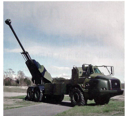
Schweden: Archer. Kaliber 155 mm. Rohrlänge 52 Kaliber. Gefechtsgewicht 34 t. Schussdistanz 50 km. Feuerschlag 3 Schuss in 13 Sekunden. Wirkungsbereich je 85 Grad. Munitionsvorrat 21 Geschosse. Bedienung drei Mann.
