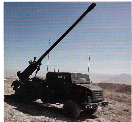
Frankreich: CAESAR (Camion Equipé d'un Système d'Artillerie). Kaliber 155 mm. Rohrlänge 52 Kaliber. Gewicht 18 t. Distanz 55 km. 6 Schuss/min. Wirkungsbereich je 17 Grad. Munitionsvorrat 18 Geschosse. Bedienung vier Mann.
