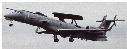
Überwachungsflugzeug der indischen Luftwaffe auf Basis des brasilianischen Embraer ERJ 145.
