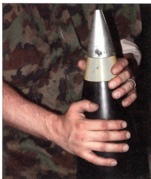
Noch immer braucht der Kanonier starke Arme: Eine Granate für die Panzerhaubitze M-109, Kaliber 155 mm.
