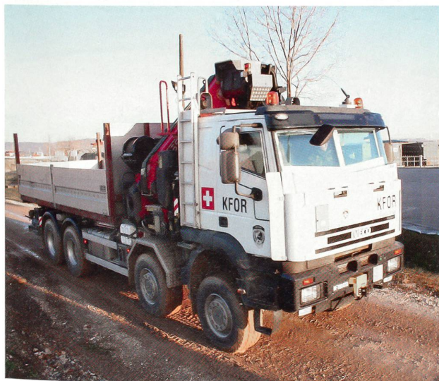
Splittergeschützter Schweizer Iveco mit einem 20-Tonnen-Kran.
