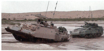
Bergepanzer Büffel im Einsatz in Afghanistan beim Bergen eines LAV-III.
