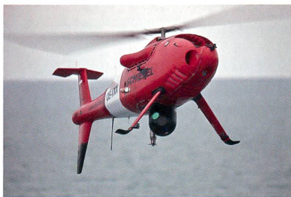
CAMCOPTER S-100 von Schiebel mit deutlich sichtbarer Sensoreinheit.
