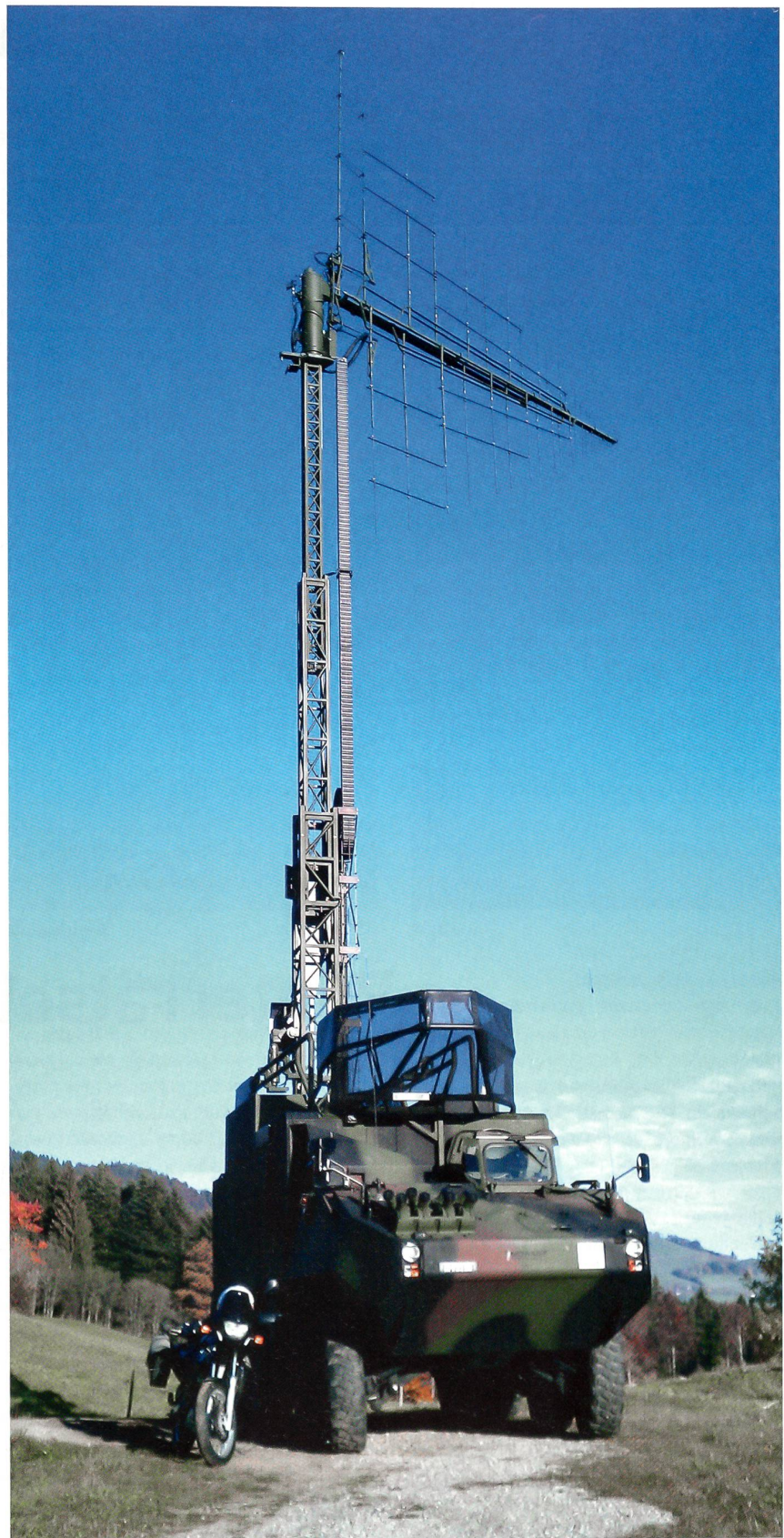
Der Schützenpanzer Piranha dient als Transportmittel für den Mehrzwecksender, der zum System IFASS gehört.
