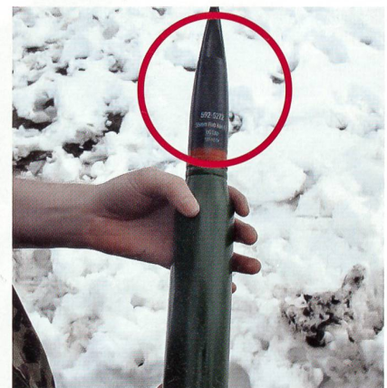
Für S-chanf wurde eine spezielle Munition entwickelt. Eingefräste Rillen an der Spitze brechen die Flugbahn früher ab.
