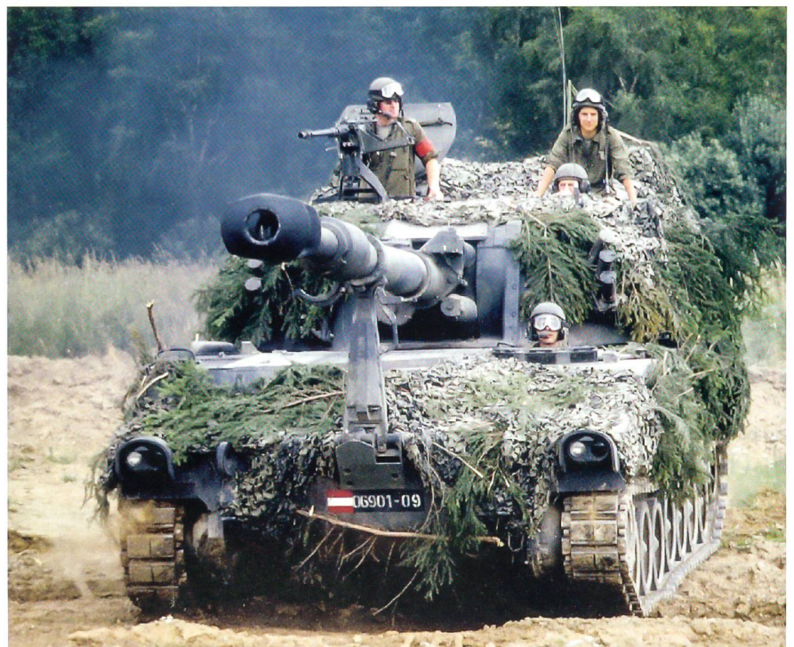
Die Panzerhaubitze M-109 ist das Einheitsgeschütz der österreichischen Artillerie. Mit ihrer 15,5-cm-Kanone unterstützt sie die Kampftruppen des Bundesheers.
