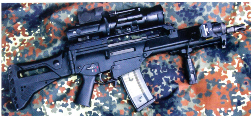
Zeiss ZO4x30, RSA-S und NSV600 und Laserlichtmodul auf modifiziertem G36K.
