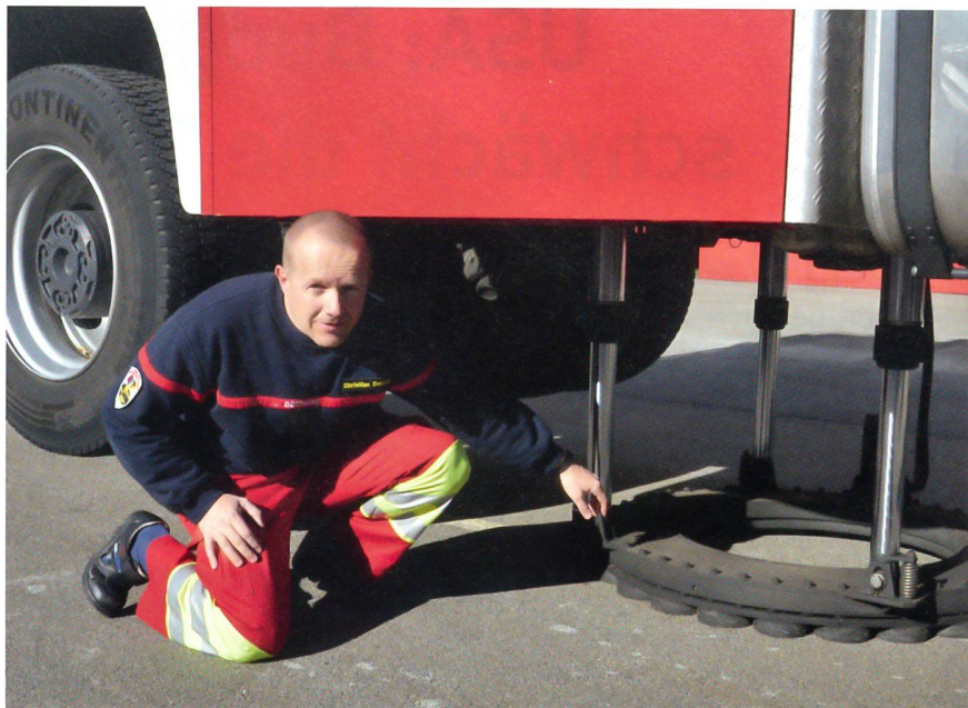
Christian Beretta zeigt den Untersatz, auf dem das Fahrzeug gewendet werden kann.
