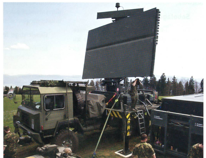
Das TAFLIR-System baut auf einem früheren Kranwagen auf.
