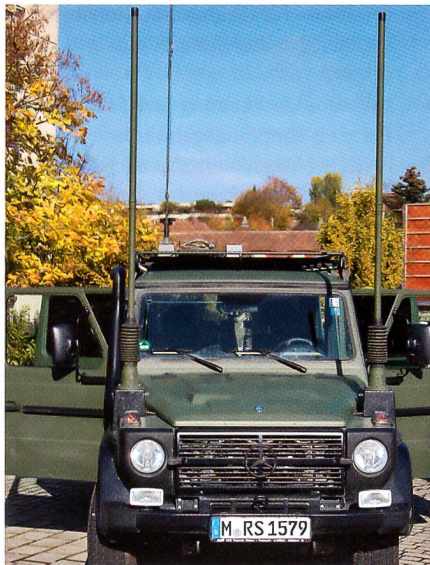
Rohde & Schwarz-Kommunikationsfahrzeug mit breitbandigen Antennen.
