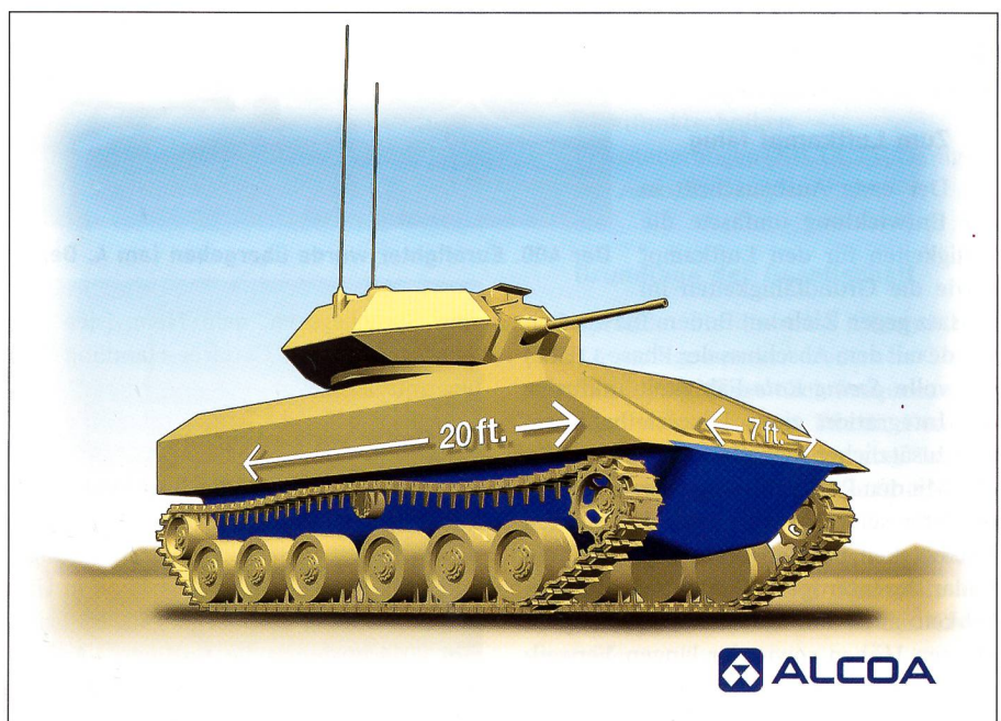
Blau erkennbar die neue Wanne aus Aluminium. 20 Feet = 6,09 m. 7 Feet = 2,13 m.
