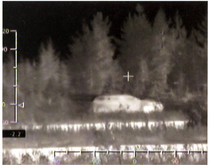
Nachts wird die Silhouette eines Autos oder eines anderen x-beliebigen Fahrzeugs oder Gegenstandes vorgetäuscht.
