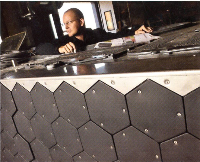
Neu am CV-90 von BAE: Mit speziellen Platten auf dem Panzer wird das Fahrzeug schwer sichtbar sogar für Nachtsichtgeräte.
