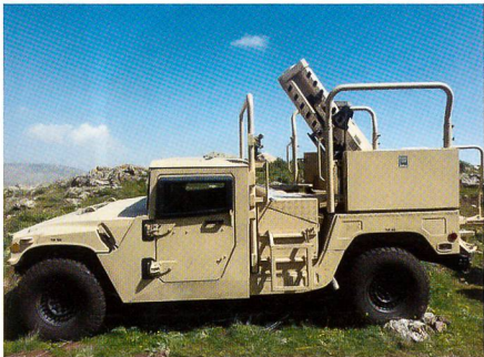
120-mm-Minenwerfersystem «SOLTAM SPEAR» von Elbit.
