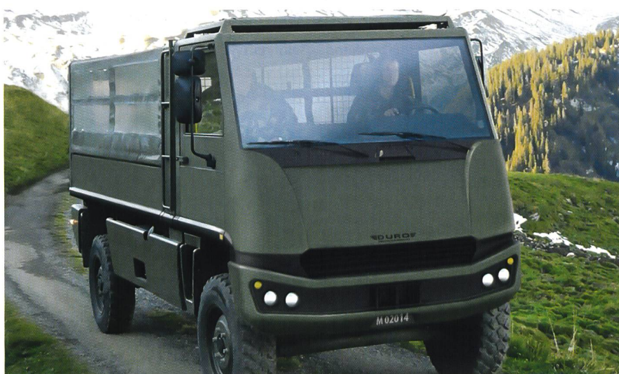
Der DURO mit modernisierter Kabine und neuem Mannschaftsaufbau.
