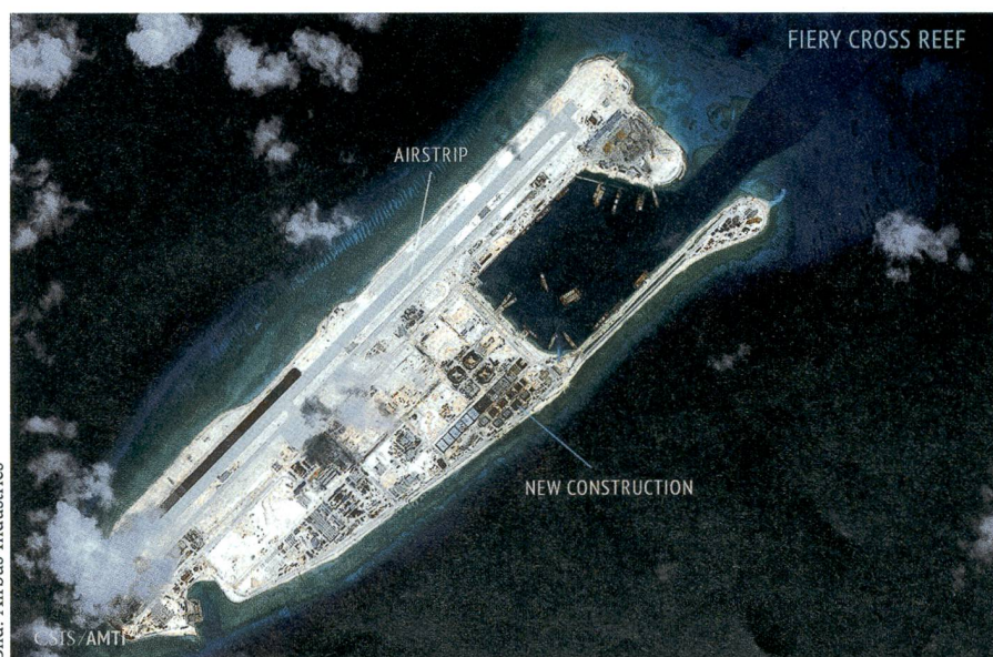
Das zu den Spratlys gehörende Fiery Cross Reef, welches in nur zwei Jahren aufgeschüttet und mit einer 3000-m-Piste versehen wurde. Die Aufnahme zeigt auch die mit Infrastruktureinrichtungen dicht bebaute Insel.
