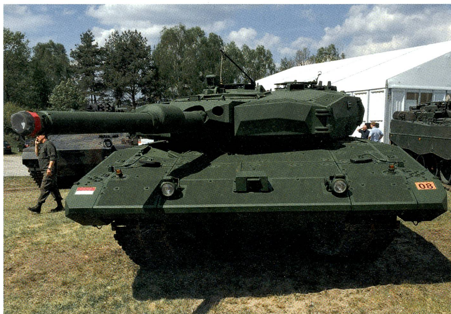
Dieser Leopard 2 wird an Indonesien in einer grösseren Stückzahl ausgeliefert. Bemerkenswert sind die intensive Farbe des Panzers und die rechts und links angebrachten Schürzen. Das Fahrzeug ist einiges breiter als die normale Ausführung.
