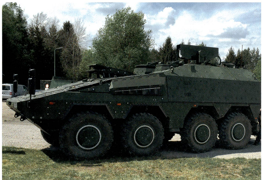
Das gepanzerte Transport-Kraftfahrzeug Boxer dient als Testplattform für die Laserkanone (HEL: High Energy Laser). Die Laserkanone ist gut sichtbar oben angebracht. Die notwendige Energieherstellung findet im Innenraum des Boxers statt.
