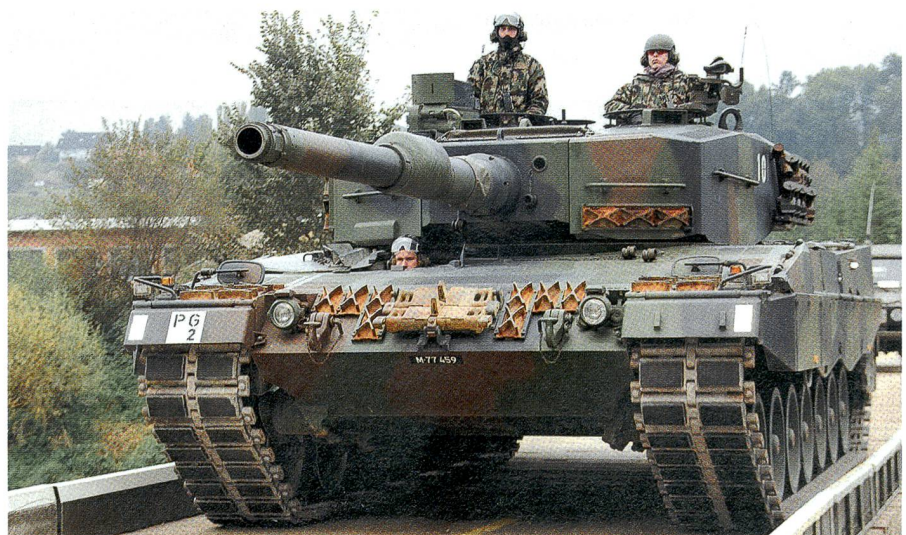
Problemlos trägt die Stahlträgerbrücke den Leopard (56 t). Der Büffel wiegt sogar 62 t.
