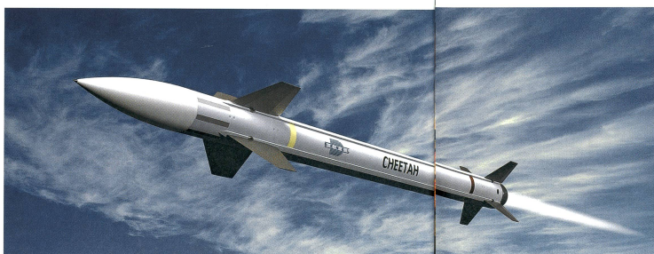
Wie der Name Cheetah der Lenkwaffe schon sagt, ist sie in der Lage, kurze Strecken mit hoher Geschwindigkeit zurückzulegen. Sie ist allwettertauglich und dient dem Kampf gegen C-Ram-Raketen und Granaten.
