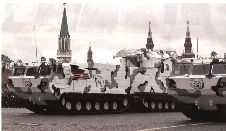
Der Arktis-Transporter Chetra TM-140A führt zusätzlich zur Besatzung acht Soldaten oder bis zu 1000 kg Fracht mit sich. Das Fahrzeug wiegt 11 200 kg, erreicht 45 km/h und hat eine Reichweite von 550 km. Es wird von der 250-PS-Gasturbine YaMZ-236-B2 angetrieben und hält Temperaturen bis zu 40 Grad unter Null aus.
