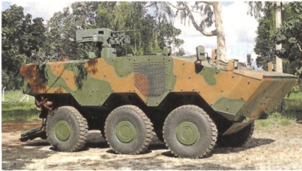
Iveco Guarani mit fernbedienbarer Waffenstation Elbit REMAX.
