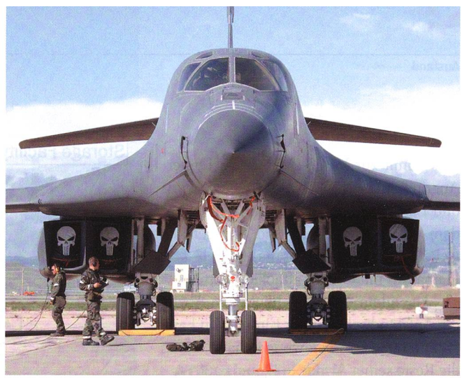
Bomber B-1 Lancer unterstützten den Luftschlag 19 Marschflugkörper AGM-158 JASSM. Das Rockwell/Boeing-Produkt trägt max. 24 Cruise Missiles. Maximale Zuladung: 60781 kg. Der B-1 ist ein schwerer vierstrahliger Überschallbomber.
